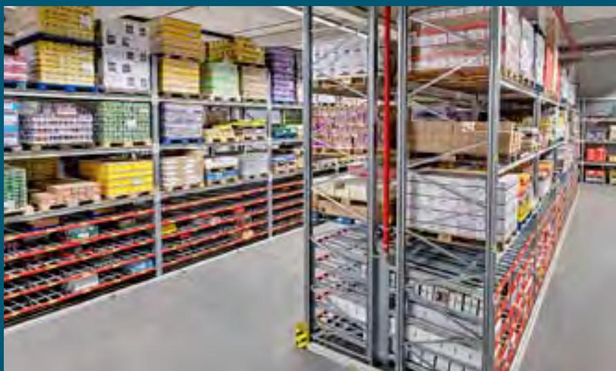
Die Trennung der Aufgabe- und Entnahmeseite unter Einhaltung des First-in-first-out-Prinzips bewirkt eine deutliche Steigerung der Kommissionierleistung.
