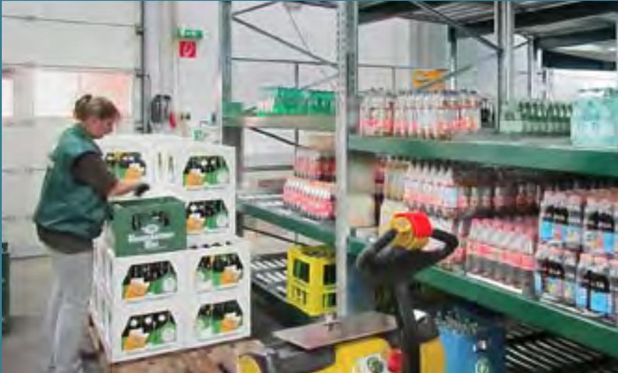
Damit die Getränkekästen jederzeit zuverlässig und gleichmäßig nachlaufen, ist es vorteilhaft, Durchlaufkanäle mit durchgehenden Rollen statt Röllchenleisten einzusetzen
