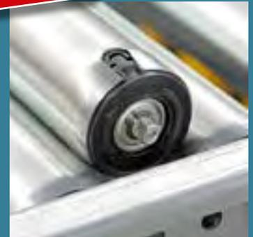
Die neue Bremsrolle sorgt für kontrollierte Durchlaufgeschwindigkeit auch bei unterschiedlich schweren Behältern
