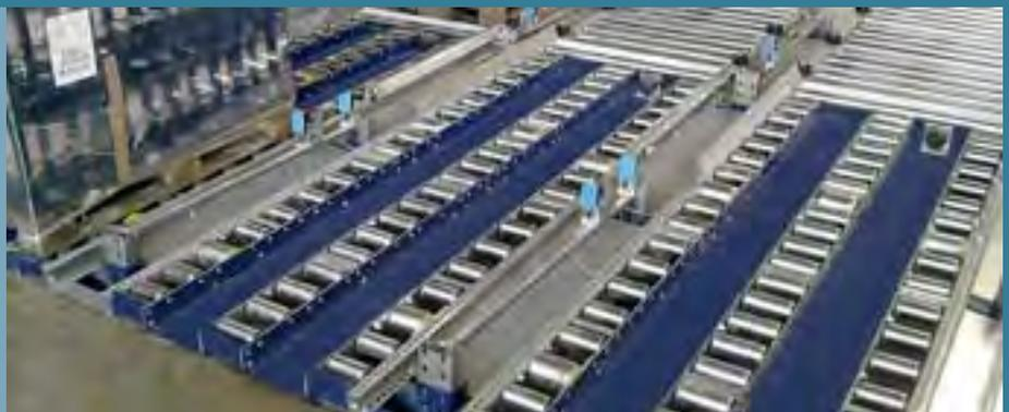
Durch Anpassungen an die Regeltechnik ist es auch möglich unterschiedlich lange und schwere Paletten (z.B. Euro und Düsseldorf Paletten) zuverlässig zu vereinzeln. Die Düsseldorf Paletten können auf Wunsch einzeln oder paarweise zur Entnahme angeboten werden.
